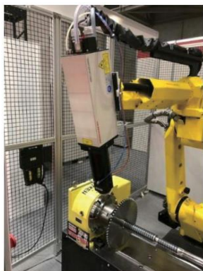
図3-26 半導体レーザーによる表面焼入れ
