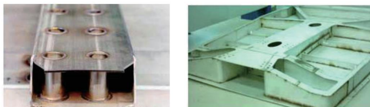
パーツの切断と溶接
