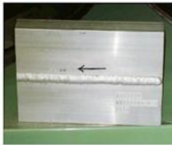
図 3-18 アルミニウムのハイブリッド溶接
